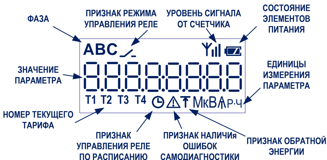
Рисунок 4.1 – Внешний вид и назначение сегментов индикатора дисплея
