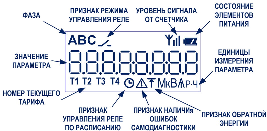
Рисунок 4.1 – Внешний вид и назначение сегментов индикатора дисплея
