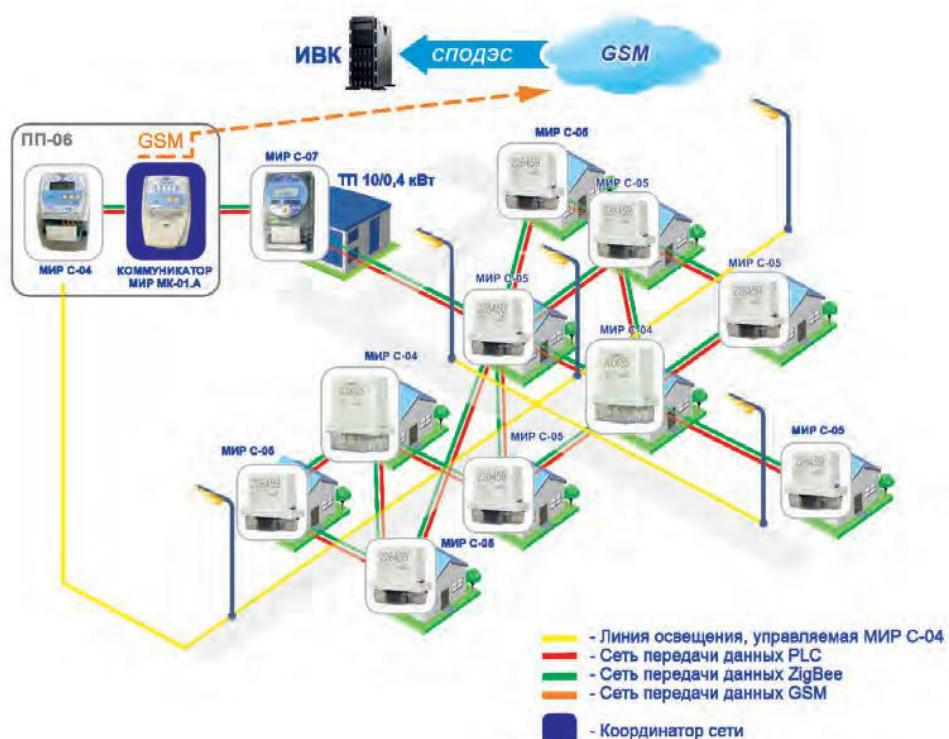
Пример интеграции функции управления освещением в ИСУЭ
