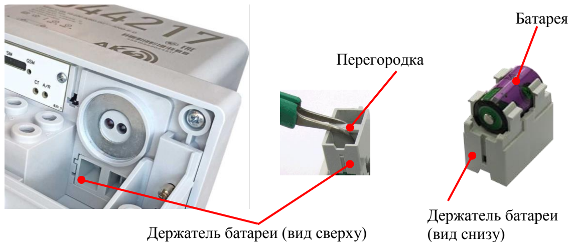
Рисунок 14.3 – Замена батареи в счетчике наружной установки
