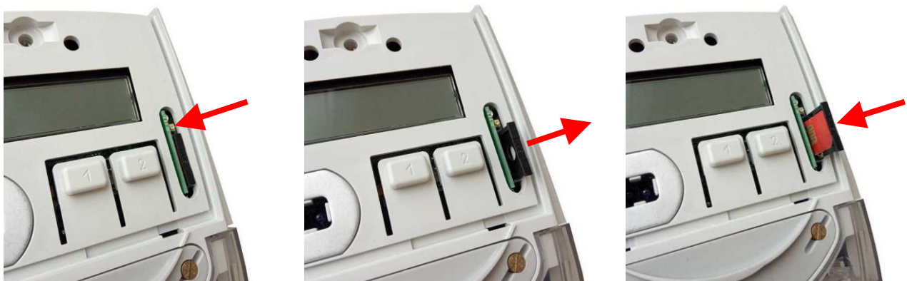
Рисунок 14.5 – Установка SIM-карты в счетчике для установки на щит
