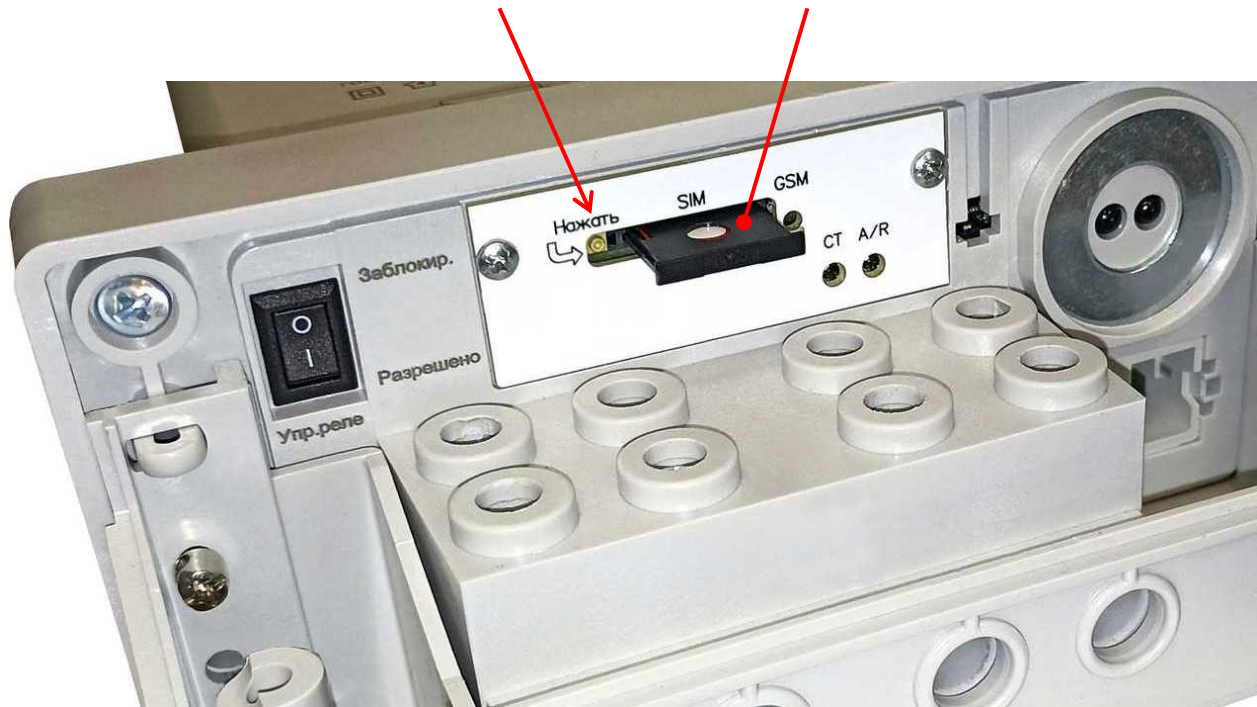
Рисунок 14.7 – Замена SIM-карты в счетчике наружной установки
