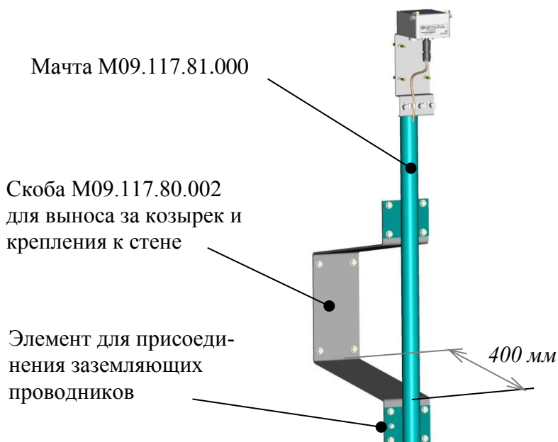
Рисунок 4.5 – Крепление радиочасов с помощью комплекта монтажных частей М09.117.80.000-03, поставляемого по отдельному заказу
