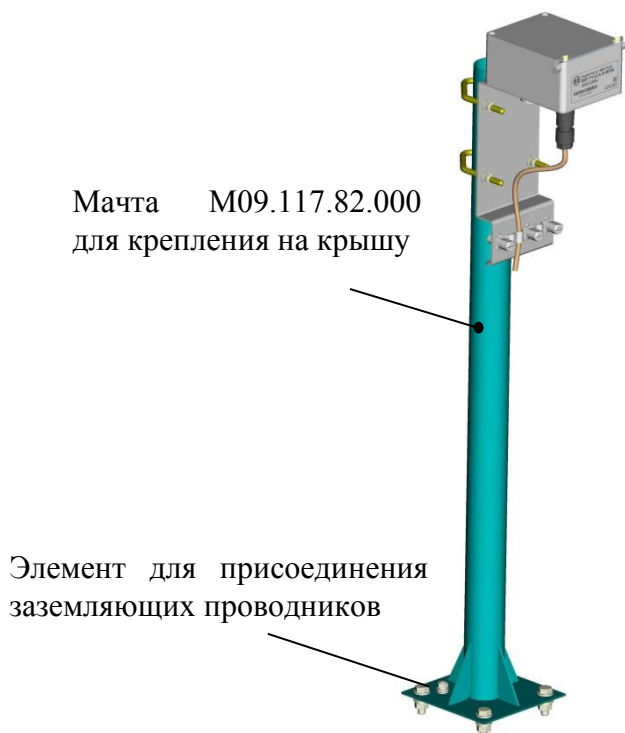
Рисунок 4.2 – Крепление радиочасов с помощью комплекта монтажных частей М09.117.80.000, поставляемого по отдельному заказу
