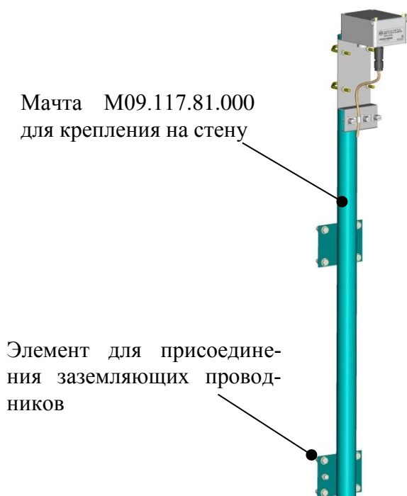
Рисунок 4.4 – Крепление радиочасов с помощью комплекта монтажных частей М09.117.80.000-02, поставляемого по отдельному заказу
