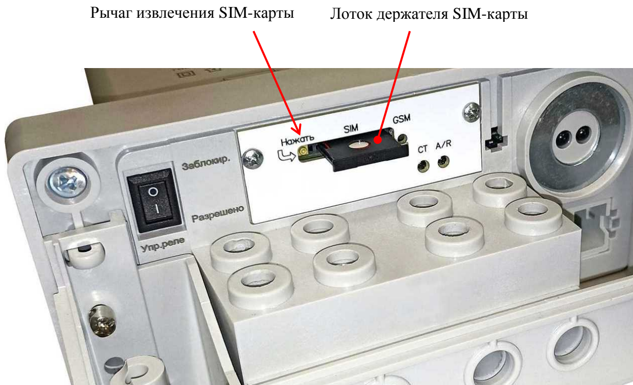
Рисунок 14.7 – Замена SIM-карты в счетчике наружной установки
