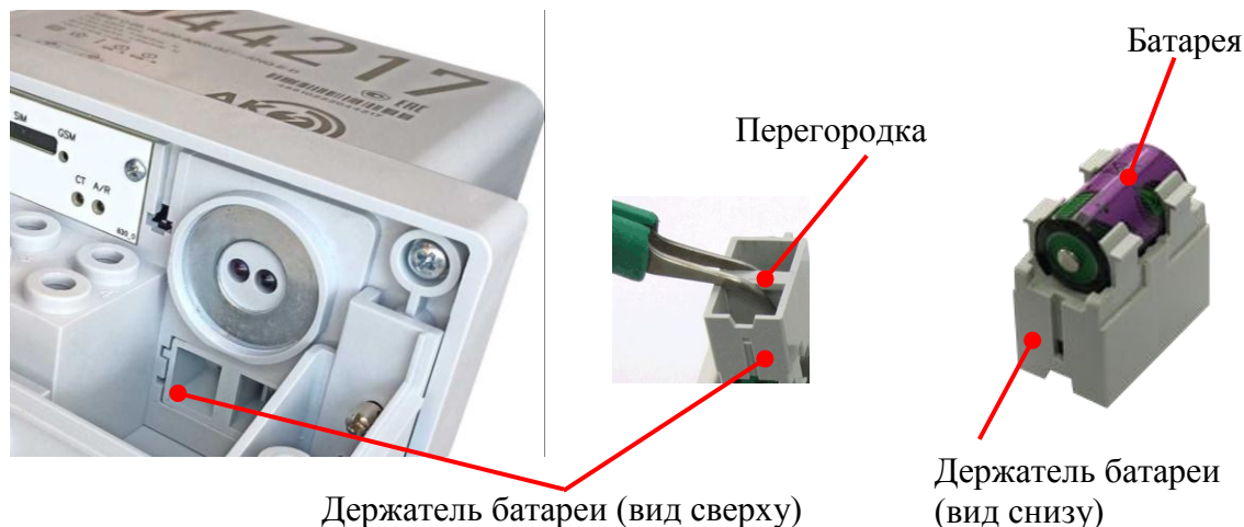
Рисунок 14.3 – Замена батареи в счетчике наружной установки
