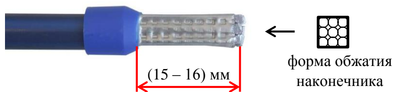
Рисунок 9.1 – Пример обжатия многожильного провода
