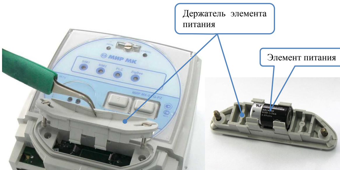
Рисунок 9.1 – Замена элемента питания коммуникатора
