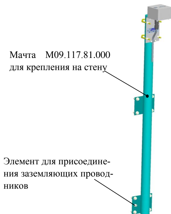
Рисунок 3.4 – Крепление радиочасов с помощью комплекта монтажных частей М09.117.80.000-02, поставляемого по отдельному заказу
