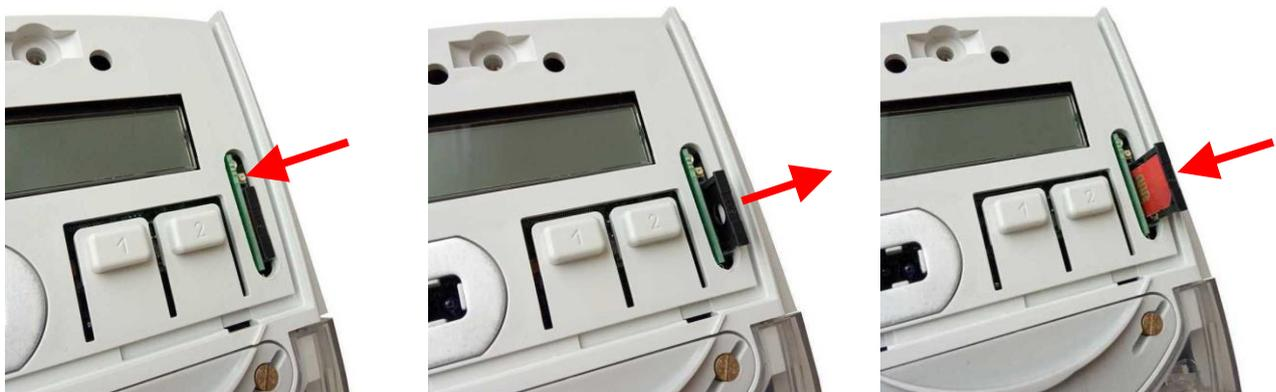
Рисунок 14.5 – Установка SIM-карты в счетчике для установки на щит
