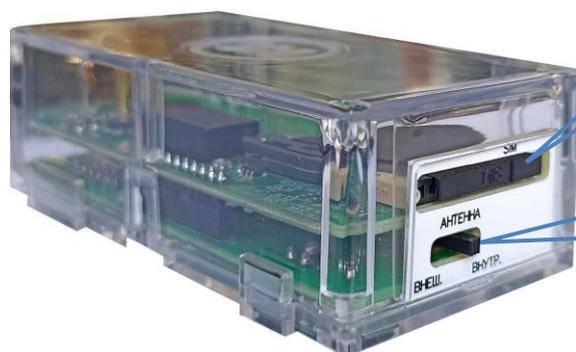
Переключатель на внешнюю антенну «АНТЕННА»
