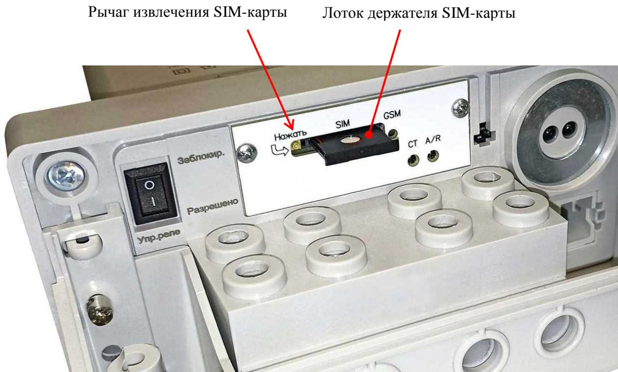
Рисунок 14.7 – Замена SIM-карты в счетчике наружной установки
