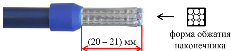
Рисунок 9.11 – Пример обжатия многожильного провода для счетчиков внутренней установки
