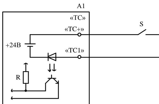
A1 – счетчик (при наличии канала ТС в счетчике);
