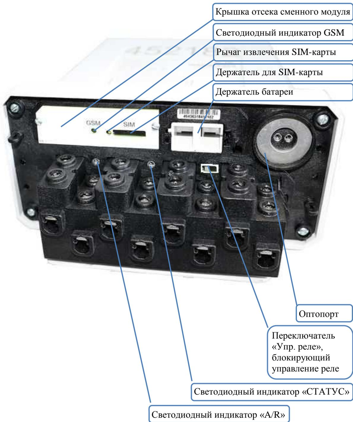
Рисунок Б.6 – Разъемы и зажимы счетчика с интерфейсом GSM, расположенные под крышкой зажимов счетчика для наружной установки
