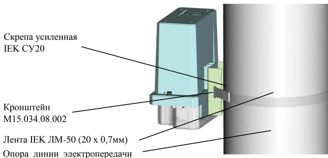
Рисунок 9.2 – Установка счетчика на опору линии электропередачи
