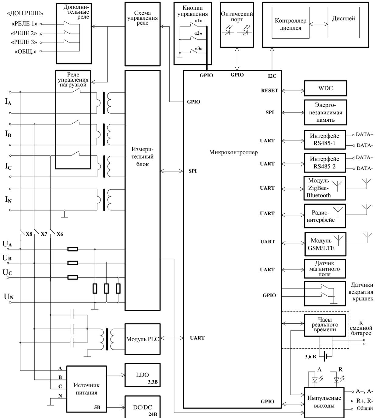
Примечание – В структуре счетчика для наружной установки отсутствуют кнопки управления, контроллер дисплея и дисплей, а также импульсные выходы. Наличие интерфейсов и других выполняемых функций – в зависимости от кода счетчика.
