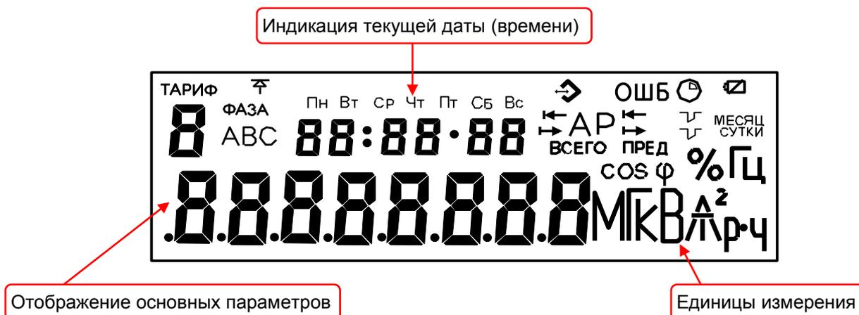
Рисунок 7.2 – Символьный дисплей счетчика
