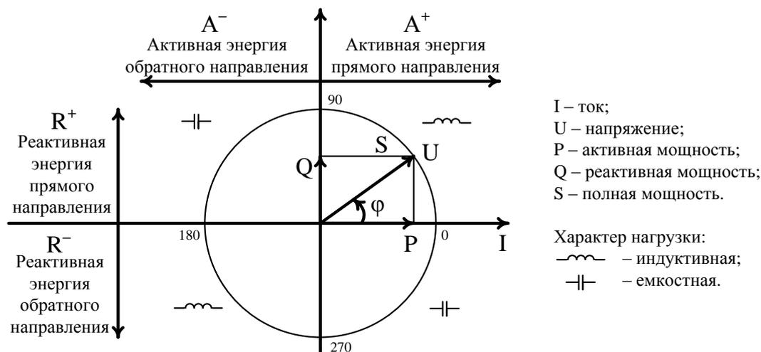
Рисунок 1.1 – Геометрическое представление активной и реактивной энергии
