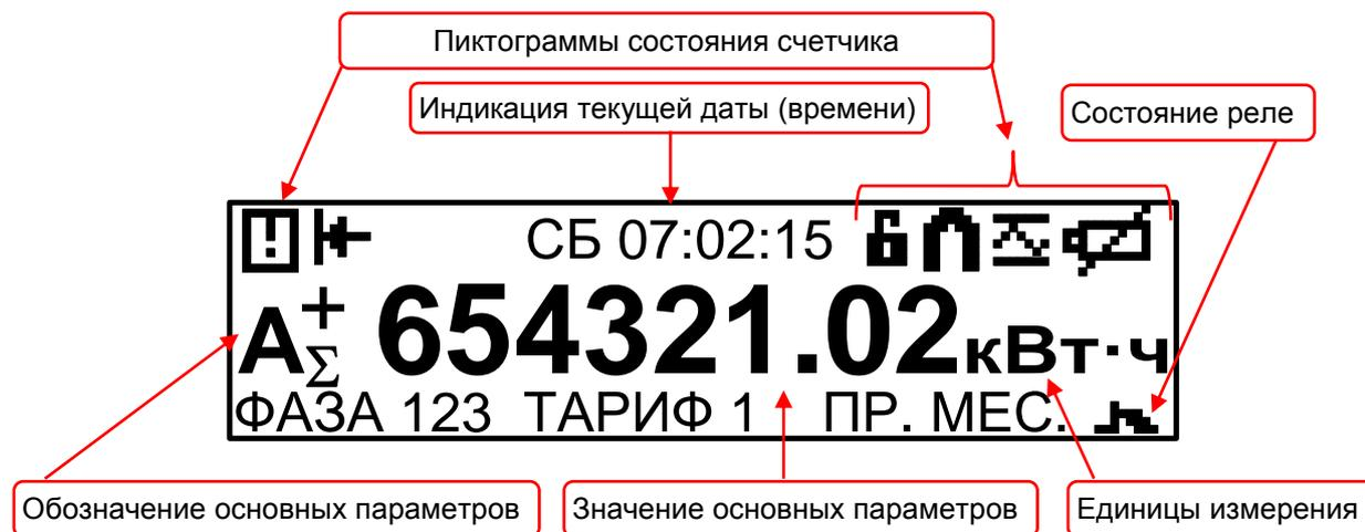
Рисунок 7.3 – Графический дисплей
