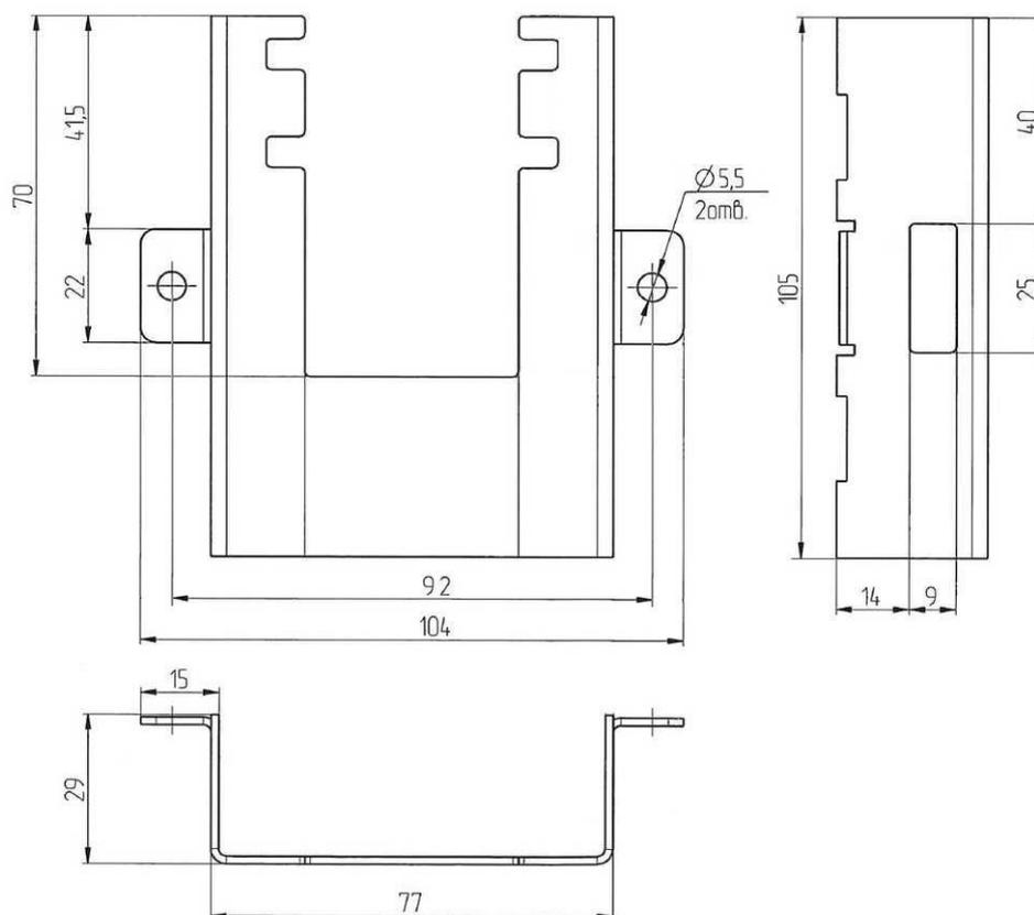
Рисунок 9.5 – Габаритные и установочные размеры универсального кронштейна
