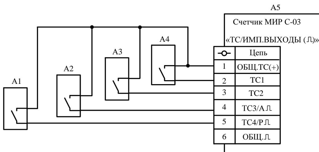
A1...A4 – датчик ТС;
