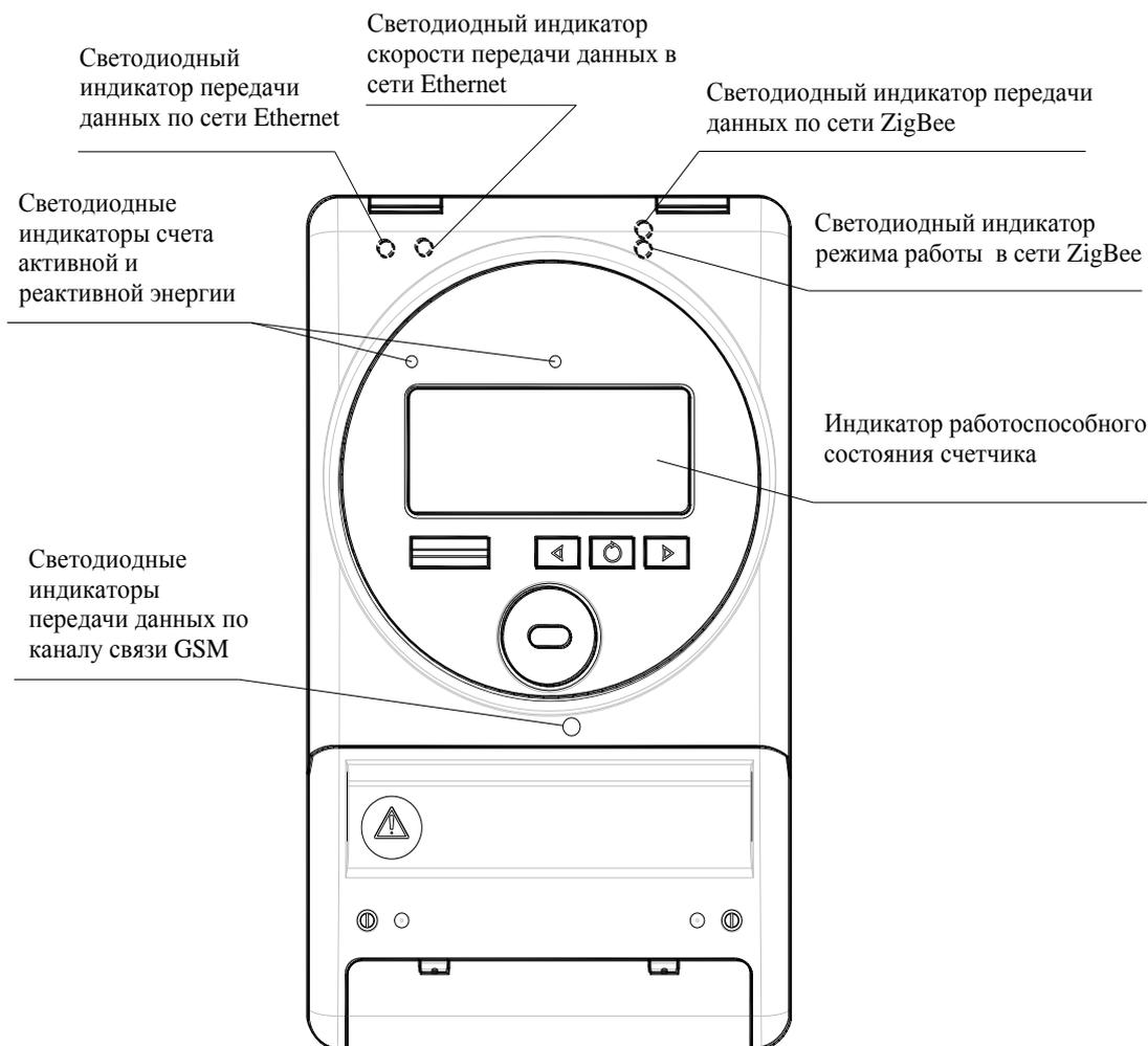
Примечание – все светодиодные индикаторы, изображенные на рисунке, кроме светодиодных индикаторов счета активной и реактивной энергии, находятся на платах счетчика и видны сквозь прозрачный кожух.
