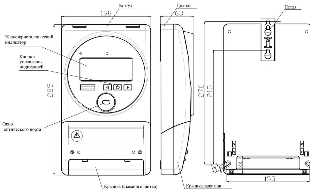
Рисунок Б.1 – Внешний вид, габаритные и установочные размеры счетчика
