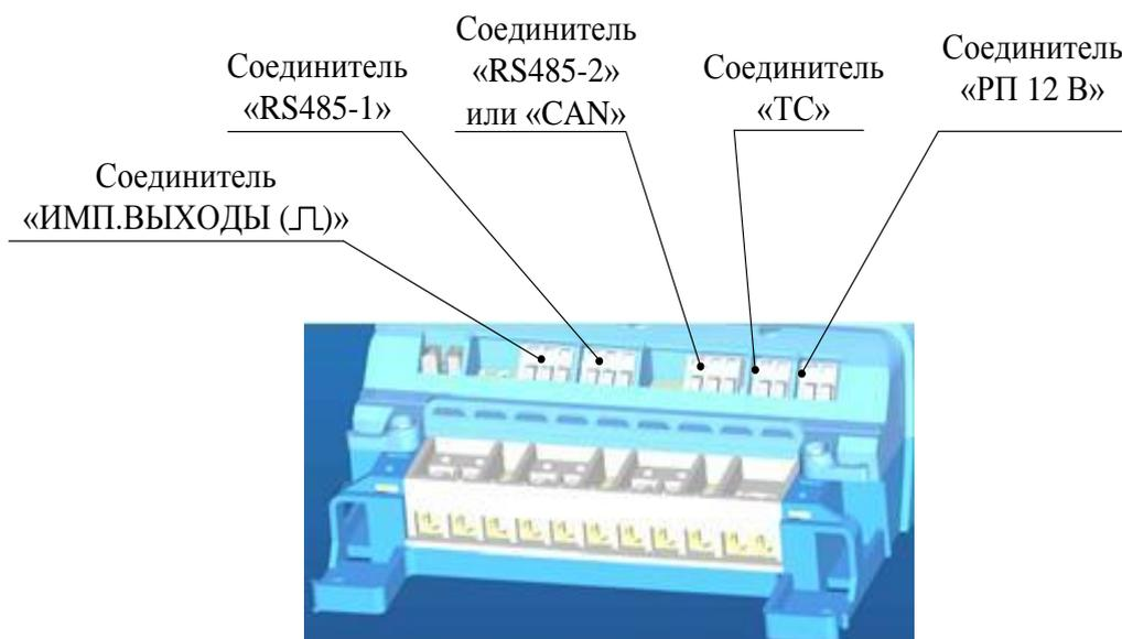
Примечание – Соединители «RS485-2» или «CAN» отсутствуют при отсутствии соответственно второго интерфейса RS-485 или интерфейса CAN.
