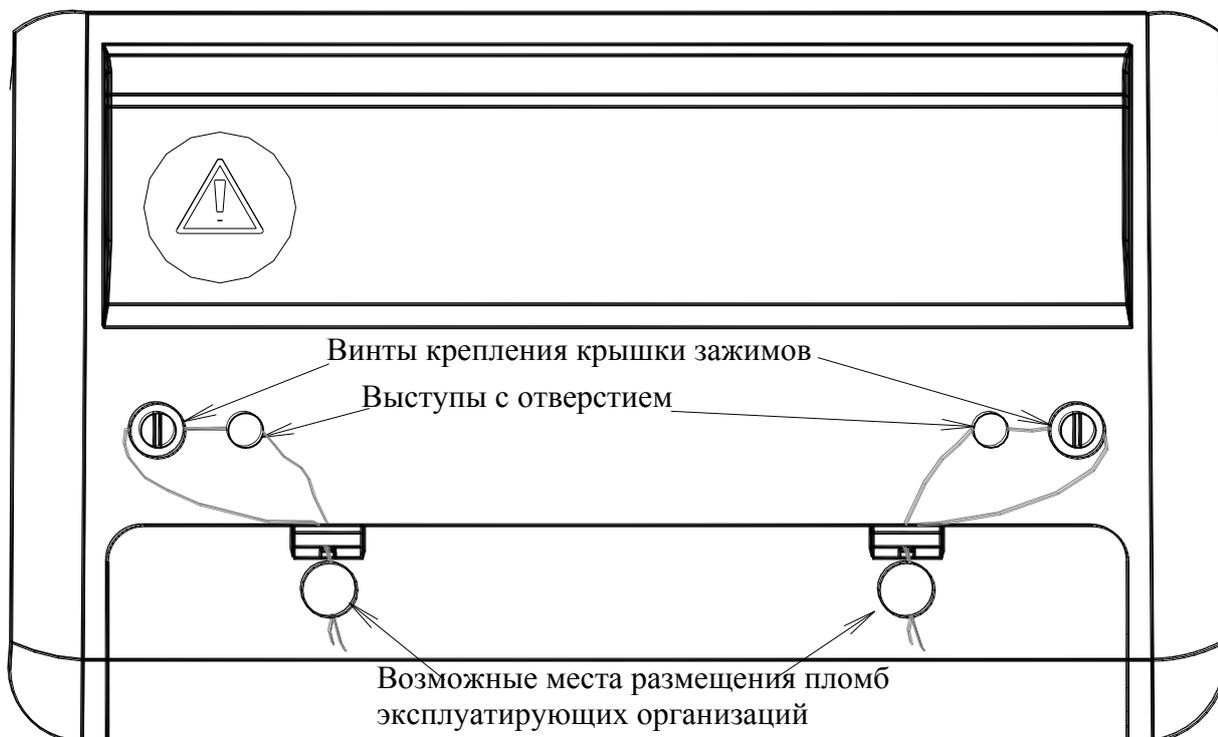
Рисунок 4.2 – Эксплуатационное пломбирование крышки зажимов
