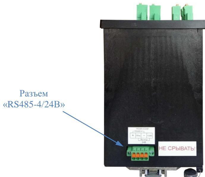
Рисунок 5.7 – Внешний вид КПП-01М (вид снизу)
