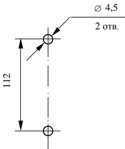
Рисунок Б.2 – Разметка мест крепления
